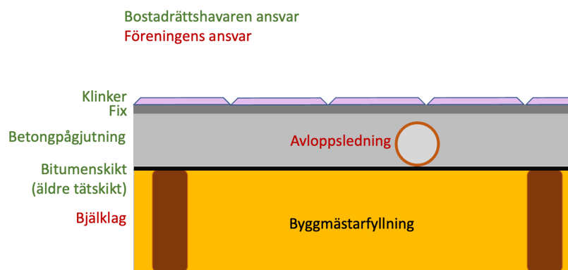
Figur 1. Konstruktion av ett äldre badrumsgolv i föreningen. Underhållsansvar för de olika delarna anges med text i grönt och rött. Bostadrättshavaren får således underhålla/reparera på de delar som har markerats med grön text. Tillstånd från styrelsen krävs för att underhålla/reparera på de delar som är markerade med röd text.
